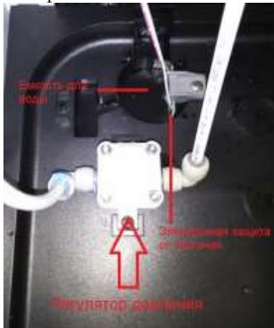
6. Если произошла протечка воды, то заполнится ёмкость, в которой установлена защита и прекратится подача воды в диспенсер. При этом будут мигать все индикаторы и раздаваться звуковой сигнал.
